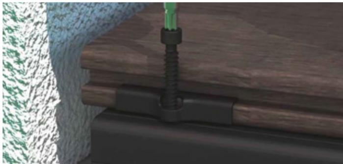
Alle übrigen Befestigungen erfolgen versteckt in den Fugen mit Tutti gli altri fissaggi sono nascosti nelle giunzioni con le clip di collegamento System49.
