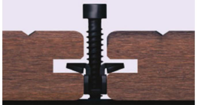
Die Schraube wird so weit festgezogen, dass die elastischen Flügel noch etwas Federweg haben. Keinesfalls darf der Kopf bis zum Boden eingedreht werden. Ein korrekt, auf kleinstes Drehmoment eingestellter Schrauber hilft dabei.
